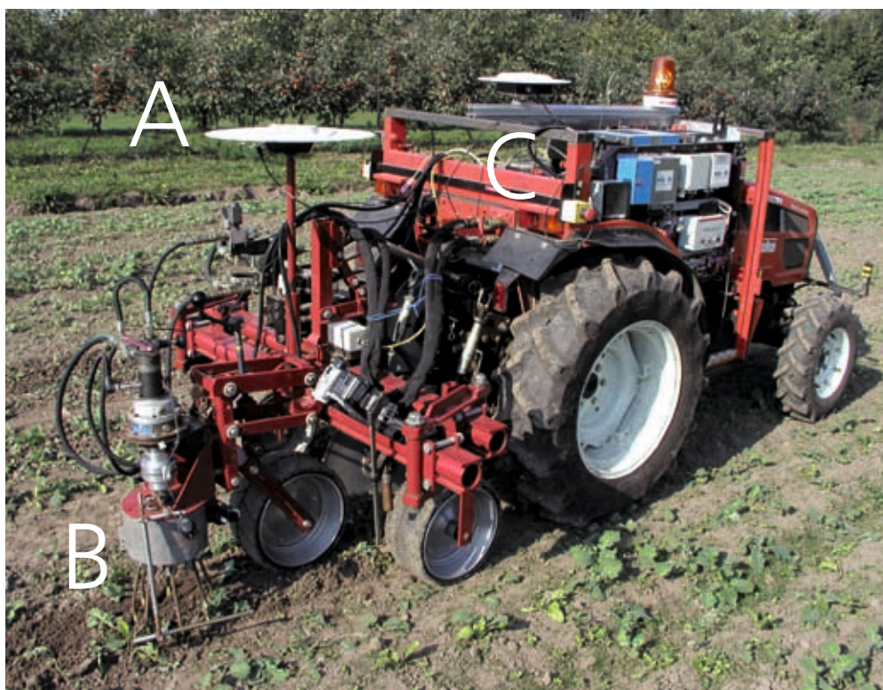
Automatisk maskine med roterende redskab og GPS til ukrudtsbekæmpelse. A: GPS antenne, B: Rotor-radrenser, C: Automatisk maskine. Foto: Hans W. Griepentrog
