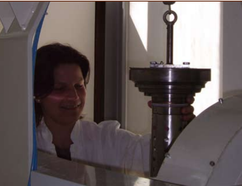
3. Maden sænkes ned i højtryksanlægget
