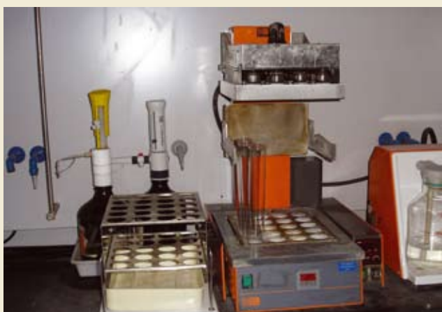
Manuel måling af protein ved Kjeldahl-metoden (tv) er langsommelig og kræver, at man bruger farlige kemikalier. Th: Et moderne måleinstrument til at bestemme protein i korn Foto til venstre: Det Biomedicinske Fakultet, KU. Foto til højre: Foss
