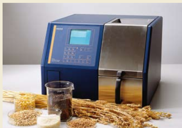
Manuel måling af protein ved Kjeldahl-metoden (tv) er langsommelig og kræver, at man bruger farlige kemikalier. Th: Et moderne måleinstrument til at bestemme protein i korn Foto til venstre: Det Biomedicinske Fakultet, KU. Foto til højre: Foss
