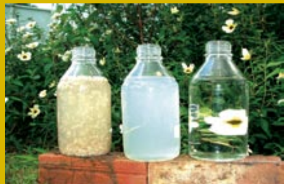
I flasken længst til venstre er der endnu olierester i vandet, men de er siet fra i den midterste flaske. Vandet i flasken til højre har været igennem et siveanlæg, der har gjort vandet langt renere end standarden for europæisk badevand.
