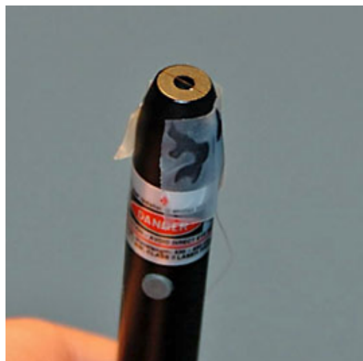
Figur 2: Et hår er sat fast med tape henover åbningen på en laserpointer.
