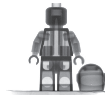
Billede skabt ved gennemlysning med neutroner.
