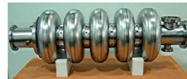
Prototype af ESS-kavitet, fremstillet af CEA Saclay.
